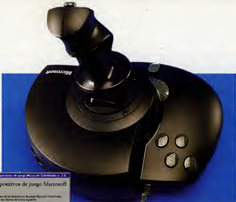
El FFP presenta tres botones en la palanca, cuatro en la base, un control de potencia, un HAT y una tecla "Shift".
